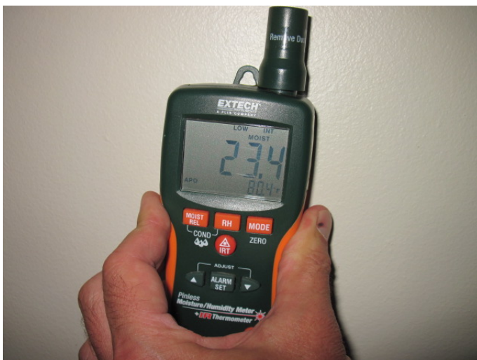
Figure 62- Lecture d'humidité indiquant un niveau au dessus des normes au 6734
